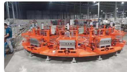
Dây chuyền lắp ráp bình nóng lạnh
